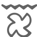
El aire calentado por el grill es dirigido por el ventilador hacia los alimentos, dentro de un rango de temperaturas entre los 50 y los 200 °C. La función Turbogrill ofrece una excelente alternativa al asador rotativo y da muy buenos resultados con aves, embutidos y carnes, incluso cuando se asan grandes volúmenes.
