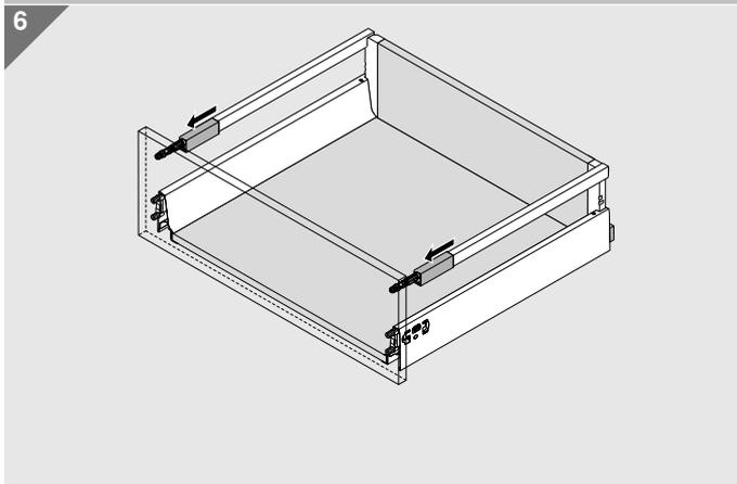
Ajuste de altura + ajuste lateral
