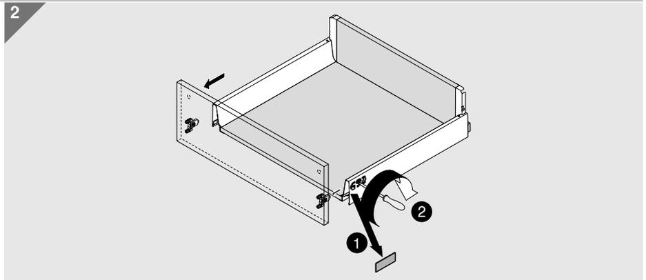
Desmontaje de guardacuerpo – Módulo extraíble interior
